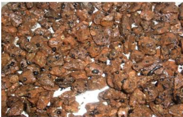
Quarzporphyr nach 48h Wasserlagerung bei 80°C mit Straßenbaubitumen
