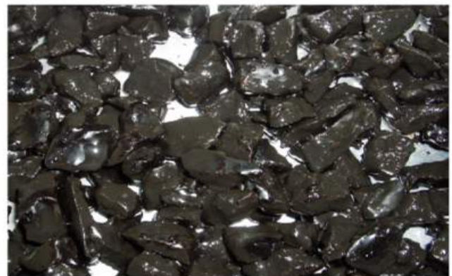
Quarzporphyr nach 48h Wasserlagerung bei 80°C mit Spezialbitumen für PFA®
